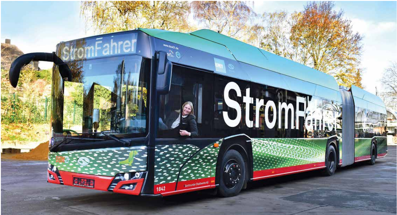
Die Reichweite der Solaris-Elektrogelenkbusse, die ab November 2022 ausgeliefert wurden, liegt bei 200 Kilometern.
